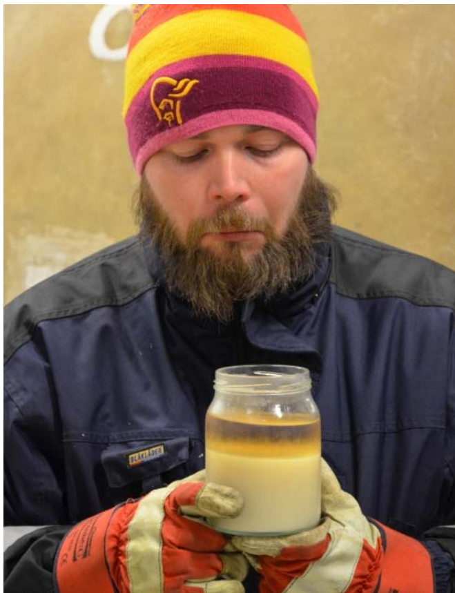
Dieselanalytiker Nils Juell uttrykket skepsis til drivstoffet på Hopen. Man kan tydelig se voksen som har skilt seg fra resten av dieselen.
