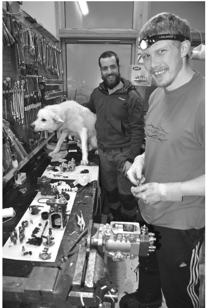
Lærling Mathias blir møkkete på hanskene under feilsøker i dieselpumpa, mens maskinmester Amund overraker prosessen, godt hjulpet av Krækling.
